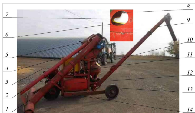
Рисунок 1. Протравливатель семян Mobitox Super, оснащенный двухдисковым распределяющим и двухуровневым отражающим устройствами: 1, 9 – шнек; 2 – труба возврата; 3 – штурвал; 4 – блок режимов работы; 5 – бункер; 6 – устройство двухуровневое отражающее; 7 – устройство двухдисковое распределяющее; 8 – дозатор лепестковый; 10 – камера протравливания; 11 – насос; 12 – бак; 13 – колесо; 14 – рама.
